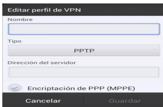
Fig. 6. Configuración para redes VPN
